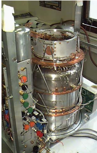
Figure 5.5: Photographie du cryostat Archeops. Les bolomètres se trouvent dans la partie supérieure du cryostat. On distingue dans la partie inférieure le réservoir d'hélium liquide.
