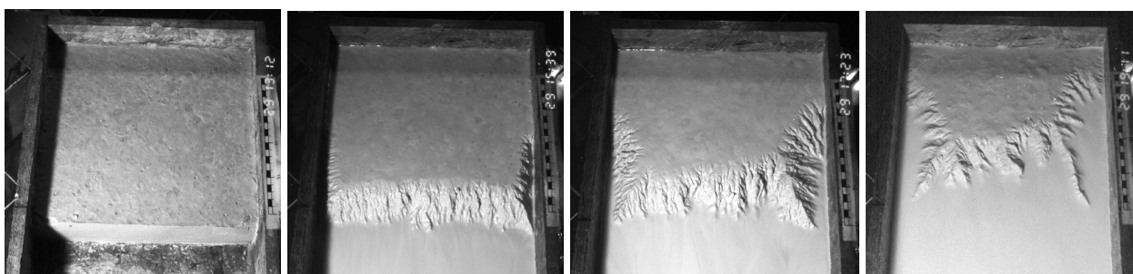
Figure B5: Evolution d'une expérience de silice en relaxation avec 3 bords fermés (28 x 28 x 4.3 cm). De gauche à droite : état initial, t=80 min, t=130 min, t=180 min. Notez la concentration de l'érosion sur les bords de la boîte
