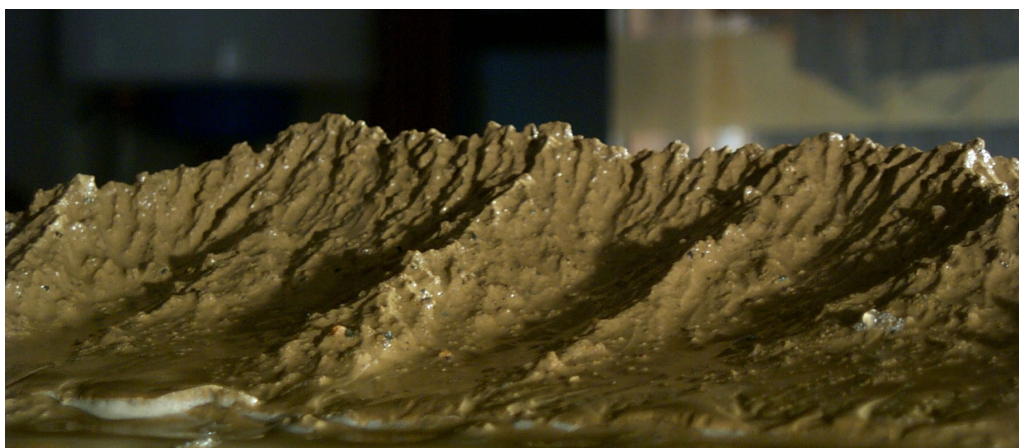
Figure 49: détail d'une expérience en relaxation, avec du loess. Le « sommet » est à 3 cm de hauteur.
