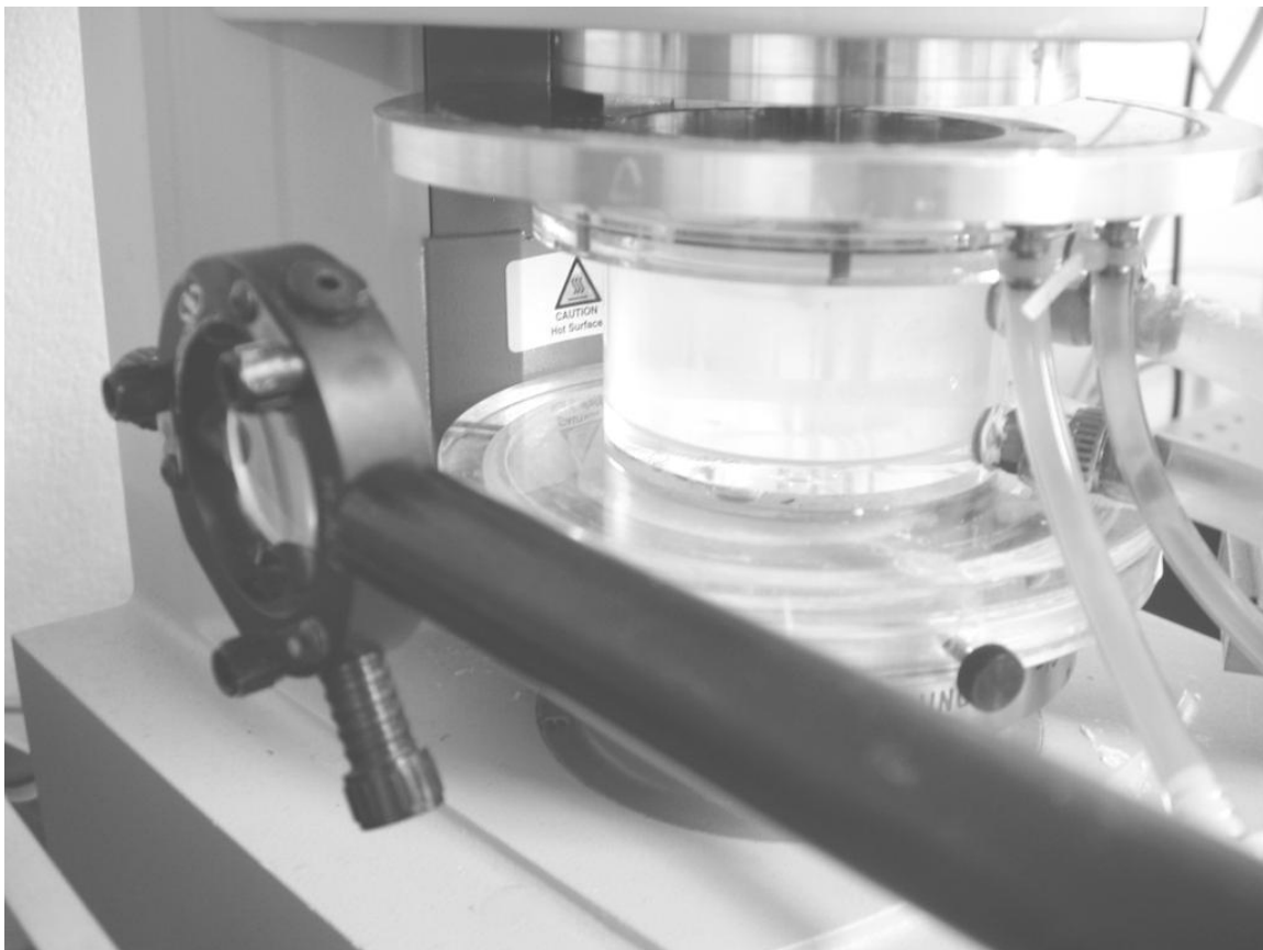
FIG. A.1 – Cellule de Couette utilisée au cours de cette thèse. Cette cellule est recouverte d'un chapeau thermostaté pour éviter l'évaporation des constituants. La lentille permet de focaliser le faisceau incident dans l'entrefer (cf. chapitre 3).
