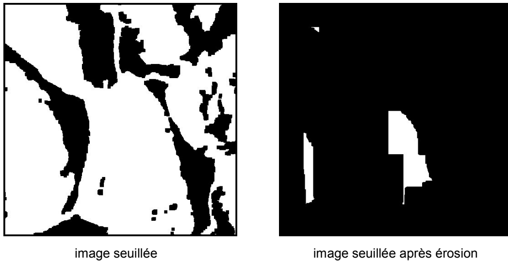
Figure 5.17 : Exemple de résultat du seuillage des zones "granulats"
