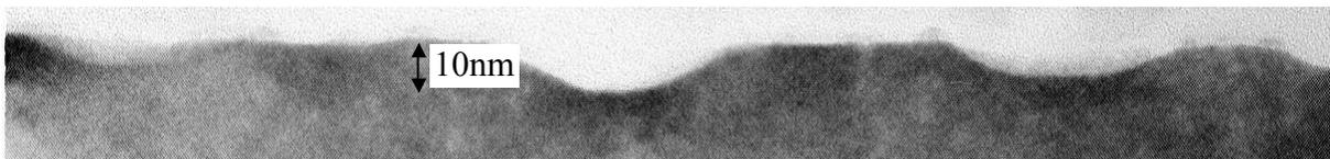
*figure 76 : Vue MET d'un film aminci à 10nm par voie chimique et recuit sous vide à 800°C. La surface s'est creusée de façon importante.*
