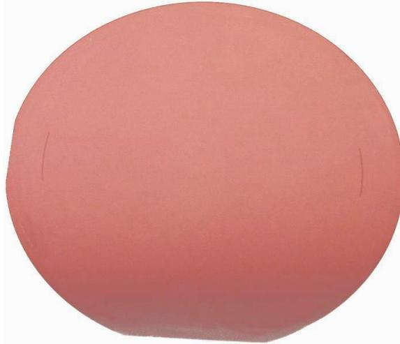
*figure 37 : Photographie d'un film fin transféré sur une plaquette de silicium de 100mm. Le film a une épaisseur de 200nm. La couleur rose n'est due qu'à l'éclairage lors de la prise de vue. Aucun défaut macroscopique n'est présent sur ce substrat auto-organisant.*
