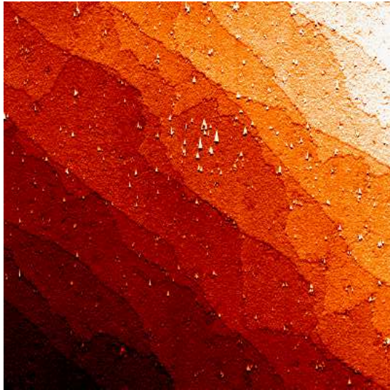
FIG. 4.4: Observation STM de la surface d'un échantillon collé à couche épaisse ( \varphi \simeq 0.44^\circ , \theta \simeq 0.22^\circ , h = 900\text{\AA} ). Echelle : 700 \times 700 nm. On observe des marches atomiques. Les points blancs correspondent soit à une pollution, soit à des piqûres d'oxyde. Bords de l'image alignés avec les directions \langle 110 \rangle . Conditions d'imagerie : 2.5 V, 100 pA.
