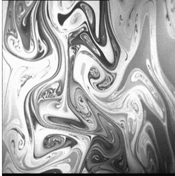
FIG. 7.3: Interférogramme typique d'un film de savon faiblement turbulent.
