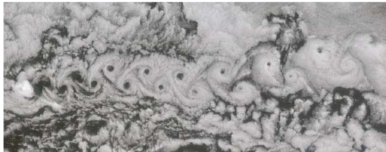
FIG. 5.1: Allée de Von Karman au dessus de l'arctique. Noter la similitude avec le sillage observé dans un film de savon de la figure 5.7.
