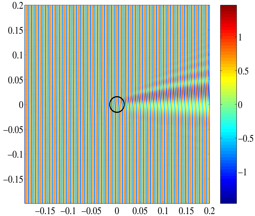
FIG. II.5 – Onde sonore totale issue de l'interaction son-écoulement pour un tourbillon à circulation non nulle (3.19) : \mathcal{M} \simeq 0.039 et \lambda/L_m = 1/2 . Les unités sur chaque axe sont en mètres.
