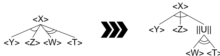
FIG. 3.6 – Transformation d'une arborescence ET-OU.
