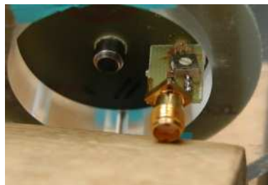
FIG. 7.19 – Photographie de l'extérieur du système court-circuit, support SMA, pion de centrage et connecteur SMA
