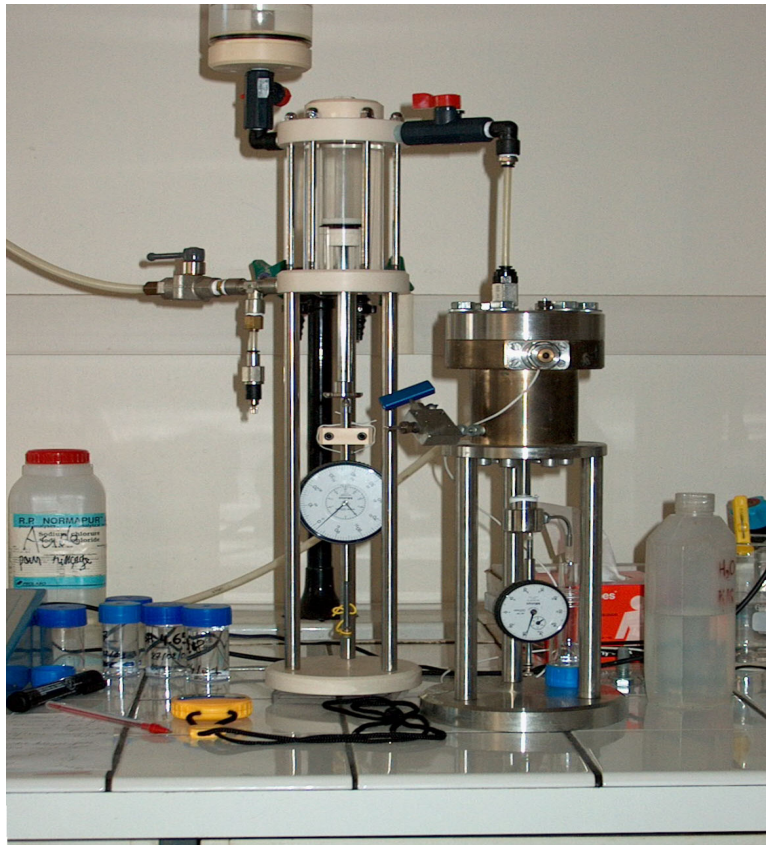
Figure A-1. – L'oedomètre seringue, construit d'après Jullien et Lecomte (2000)
