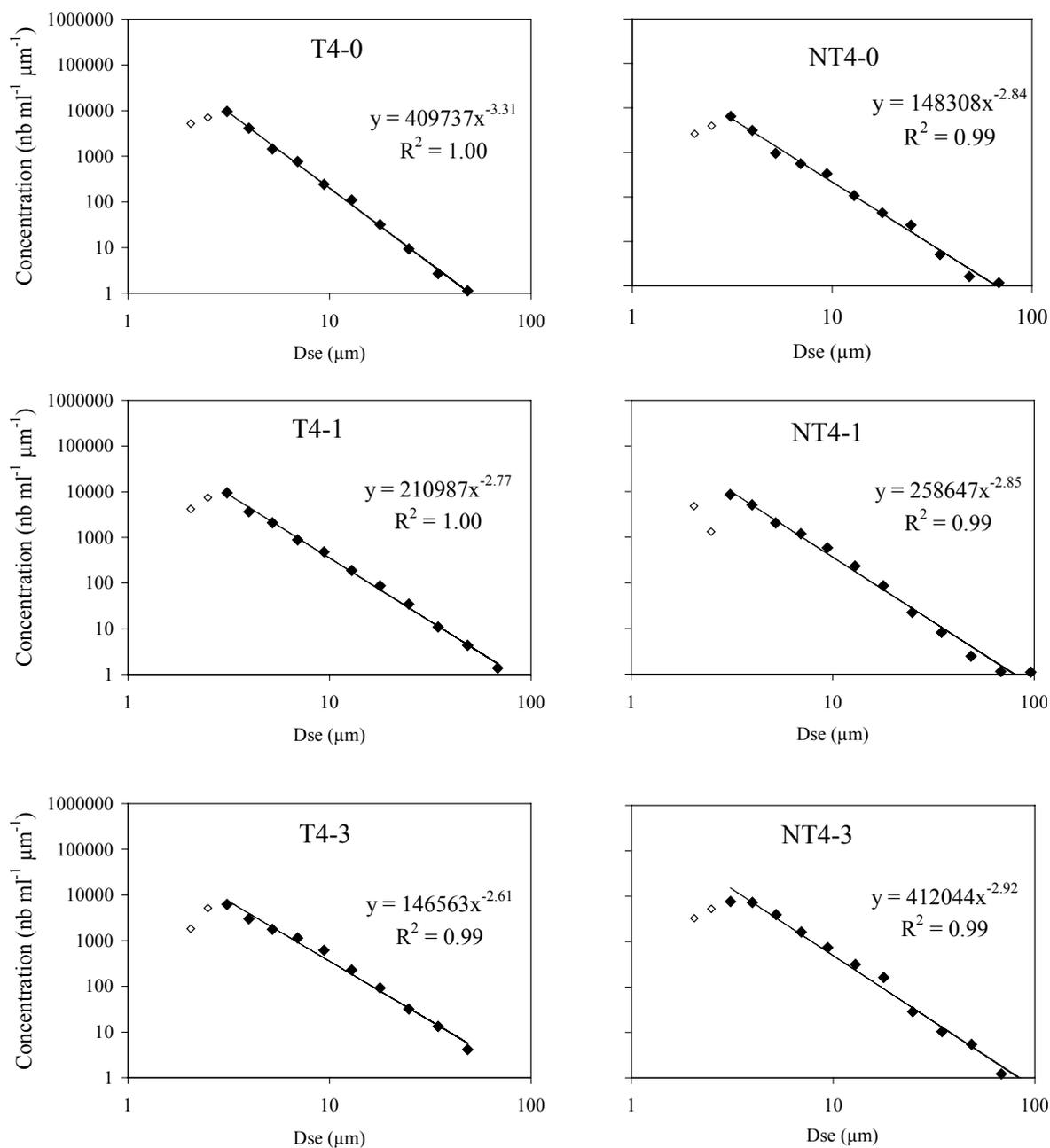
**Annexe C7 : Spectres de taille des TEP dans les mésocosmes T4 et NT4, depuis les conditions initiales jusqu'au jour 3 de l'expérimentation.**
