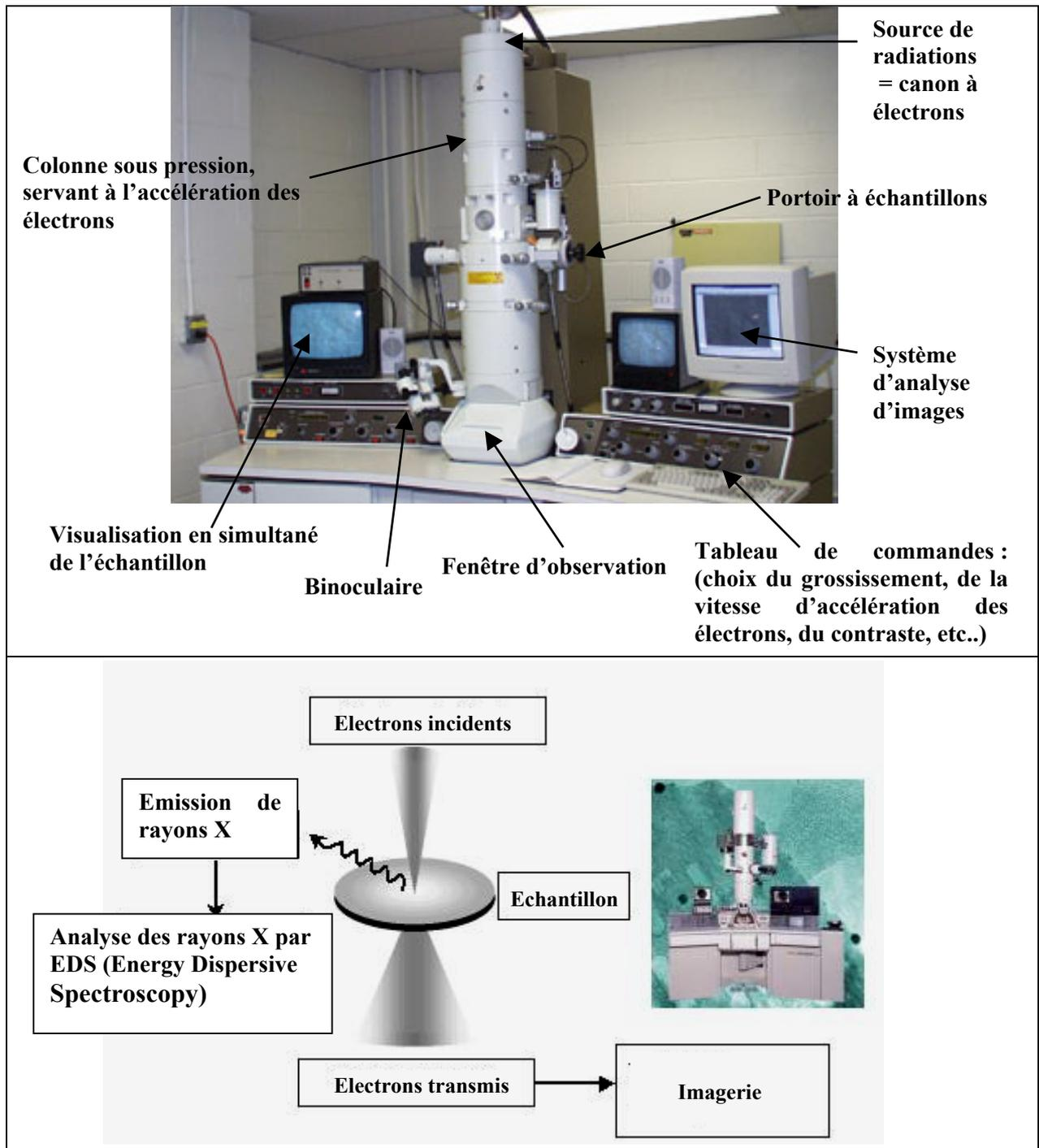
Figure V-1: Photographie d'un microscope électronique à transmission couplé à un micro-analyseur à rayons-X (haut). Schéma du principe de fonctionnement du MET-rayons X (bas). (Photo issue du site <http://lifesci.rutgers.edu/~cbn/emlab/jcol.html>. Schéma tiré du site <http://catalyse.univ-lyon1.fr/smic1.html>).
