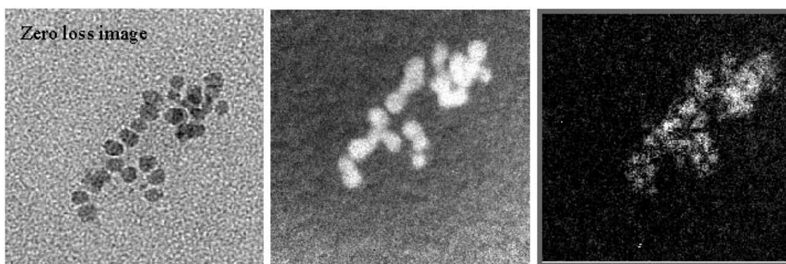
FIG. 4.32 – Particules de \text{Co}_1\text{Rh}_1 dans le PPO. A gauche : image sans perte, au centre : rapport des images avant et après le seuil de Rh, à droite : cartographie du Co, réalisées par EFTEM.
