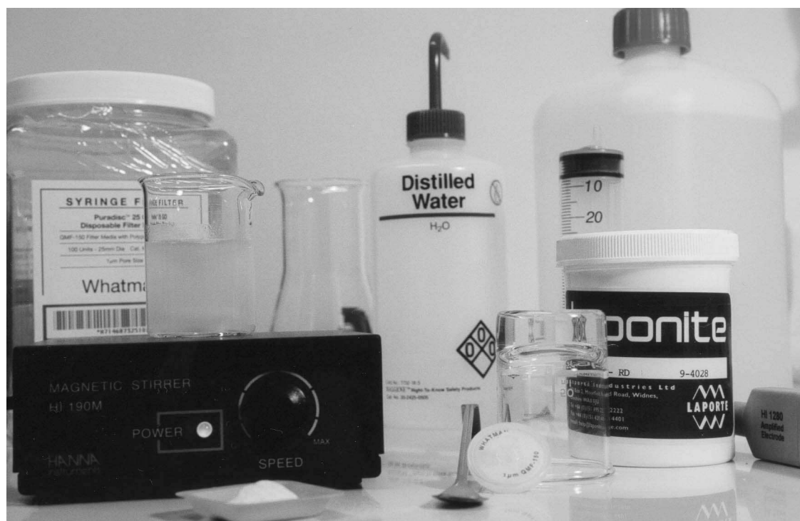
FIG. 4.1 – Préparation de la Laponite. La Laponite se présente sous la forme d'une poudre blanche que l'on mélange avec de l'eau distillée à l'aide d'un agitateur magnétique. Son aspect laiteux (à gauche) disparaît après quelques minutes, et la solution forme après filtrage un gel transparent : le bécber renversé sur la droite de la photo contient une préparation de concentration massique 3%, âgé d'une journée.
