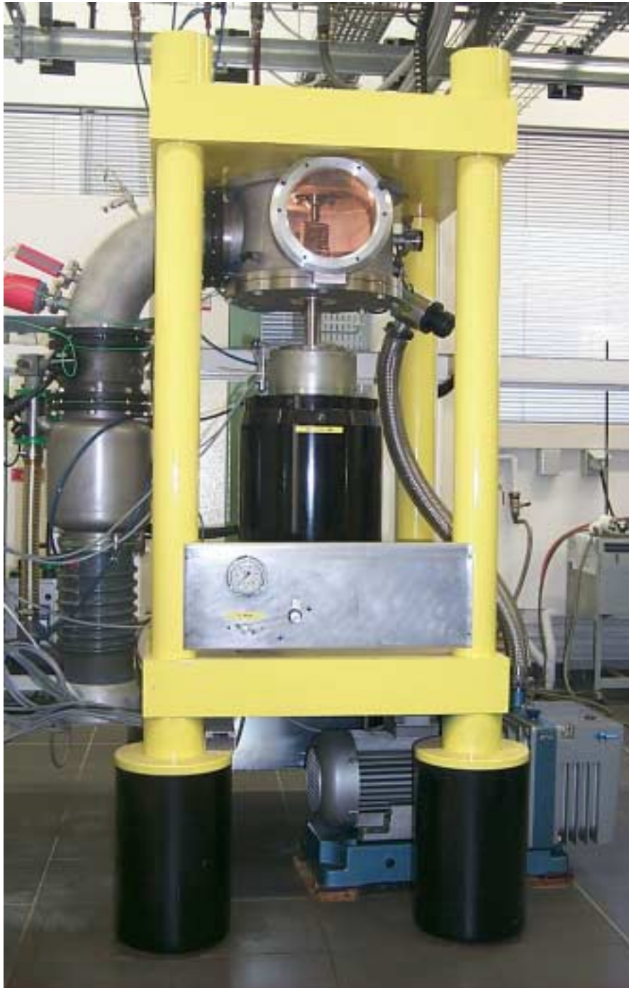
FIG. 4.2 - Photographie d'ensemble du pilote de compression uniaxiale à chaud
