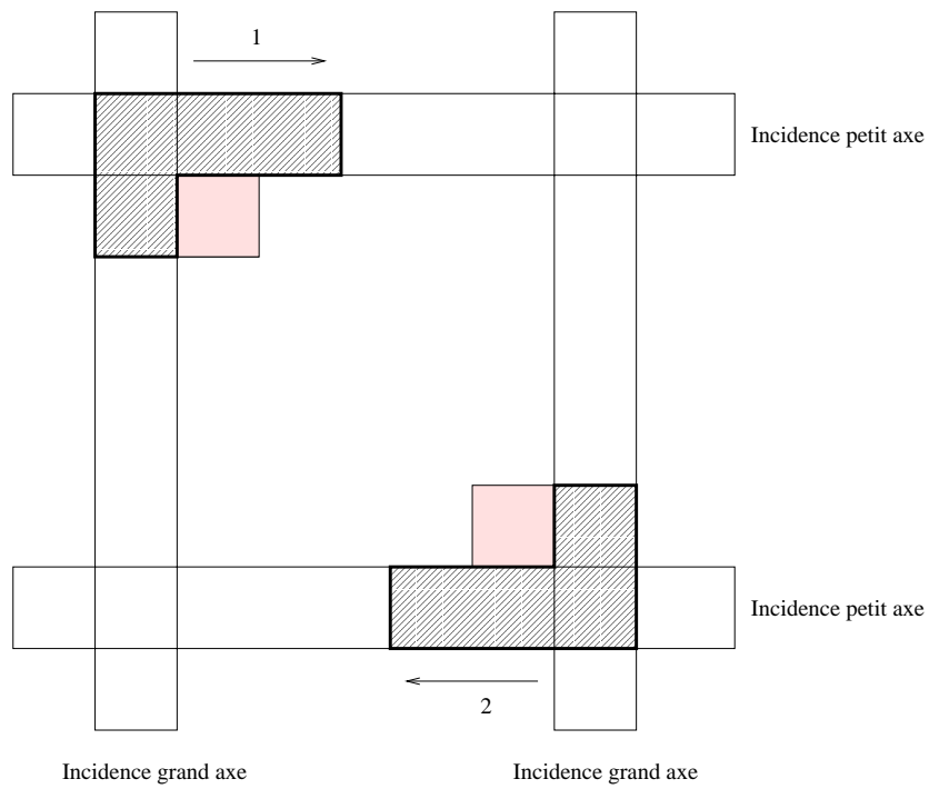
FIG. 5.12 – Interpolation entre deux paires de coupes grand axe et petit axe. Le pixel interpolé (en gris) est obtenu par l'application du masque (zone hachurée) dans le sens 1, puis le sens 2.
