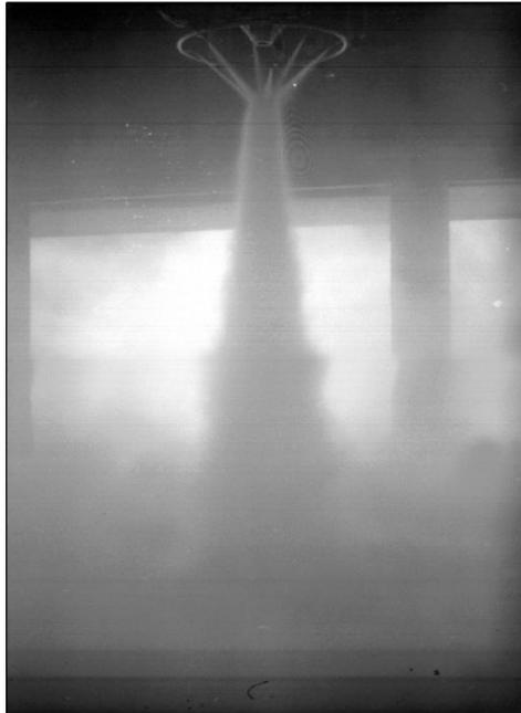
FIG. 2.16 – *Injection d'eau dans un jet supersonique (banc MARTEL)*
