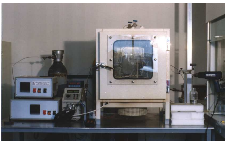
Figure 2.2 : Le montage expérimental : ①- source de solvant ; ②- réfrigérant ; ③- pompe haute pression ; ④- étuve ventilée ; ⑤- contrôleur de pression (mesurée en P) ; ⑥- contrôleur de température ; ⑦- disque de rupture ; ⑧- piège à solvant ; ⑨- cellule de décomposition ; ⑩- vanne.
