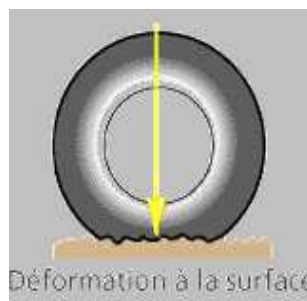
FIG. 1.1 – Exemple de déformation-contact d'un pneumatique
