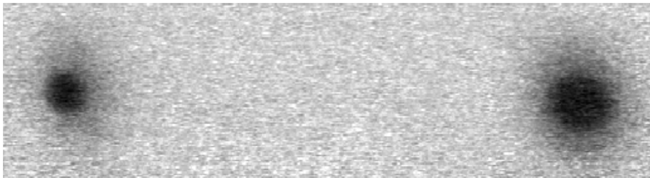
FIG. IV.25 – Image en absorption d'un condensat contenant les deux espèces |2, 2\rangle et |1, -1\rangle . Un gradient appliqué brièvement durant la coupure permet de séparer par effet Stern et Gerlach les deux condensats. Après un temps de vol de 20 ms, la séparation apparente des deux nuages est de 1,5 mm.
