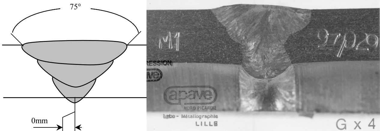
Figure VI.13 : Soudure circulaire TIG manuelle sur un tube de 316L, \phi 26mm d'épaisseur 6mm, réalisé en 3 passes (jeu nul, talon nul, 230A)
