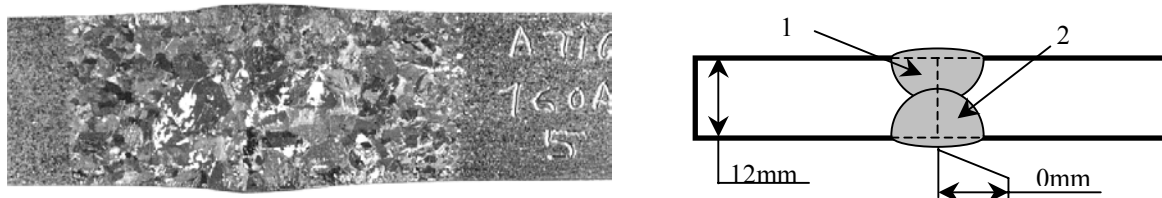
Figure VI.16 : Soudures manuelles ATIG en deux passes recto verso - 160A (T40)
