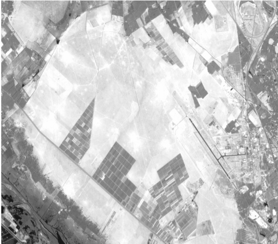
Figure 4-2 : Gros plan sur la plaine de La Crau dans le canal MIR, image du 24/06/1999 à 10h26. On distingue nettement les chemins qui permettent de repérer le site d'étalonnage.
