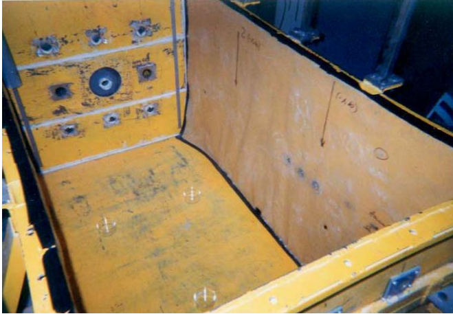
Figure 1 : Couche de glissement installée sur un côté de la chambre de calibration
