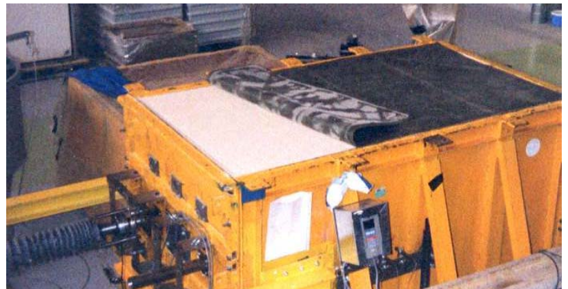
Figure 2 : Vue du matelas gonflable disposé au dessus du massif de sable
