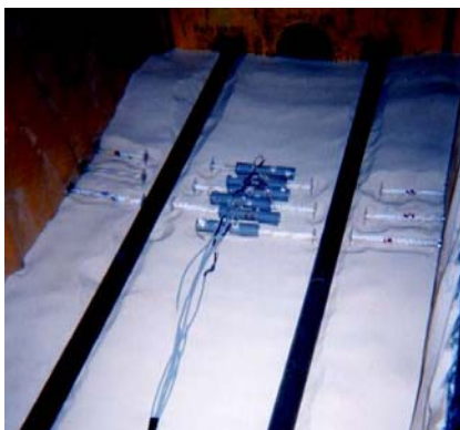
Vue des 12 capteurs LVDT 25mm disposés autour des deux tuyaux
