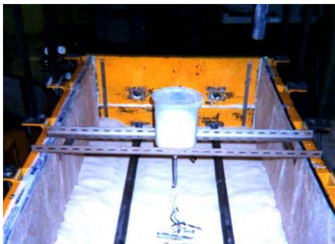
Figure 4 : Vue du mini pluviateur
