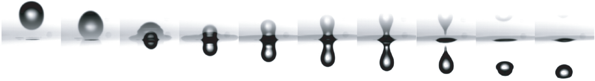
FIG. 3.21: Série de photos illustrant l'éjection d'une goutte unique sous la surface. La goutte est calibrée par le trou (ici r = 390 \mu\text{m} ). La goutte mère de 1.8 mm de rayon est d'huile silicone (de tension \gamma = 16 \text{ mN/m} et de viscosité \eta = 0.5 \text{ mPa.s} ). La vitesse d'impact de 40 cm/s est légèrement supérieure à la vitesse seuil. L'intervalle entre les photos est de 2 ms.
