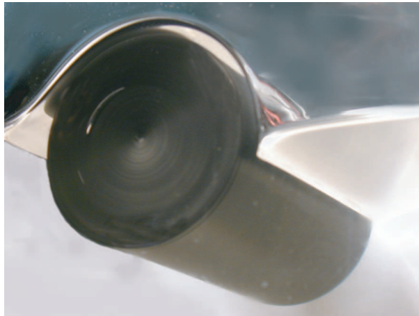
FIG. 6.6: Photographie du rouleau et de la pointe liquide prise de trois-quart.
