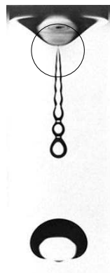
FIG. 6.1: Une goutte d’eau et un filament de liquide se détache d’un capillaire. Noter la forme conique du filament près du point de détachement. Clichés X. Shi et S. Nagel [145].
