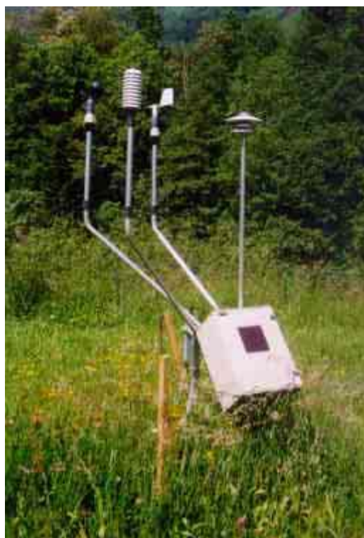
Photo 6 : Station météo Enerco 407 installée à Sarrance
