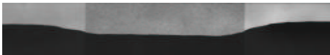
Fig. 2.6: Déformation de la ligne de contact induite par les bords de la partie gravée. La partie gravée (bande sombre centrale) est large de 20 mm.
