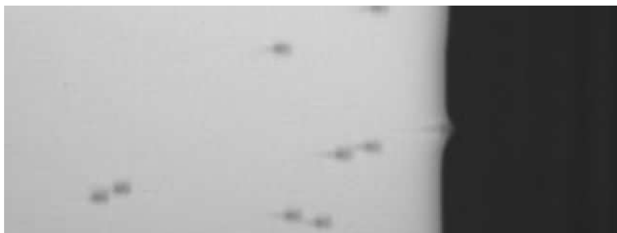
Fig. 6.5: Image typique relevée au cours de nos expériences. L'aspect rectangulaire des défauts est dû à l'acquisition de seulement une ligne sur deux. Le champ de l'image est horizontalement de 438 \mu\text{m} et verticalement de 329 \mu\text{m} .
