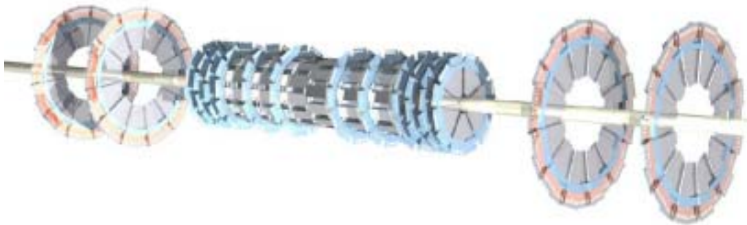
FIG. 2.10 – Structure du détecteur de vertex au Silicium (SMT). Il est composé de 6 modules "barillets" (barrel), de 12 disques F, et de 4 disques H plus vers "l'avant".
