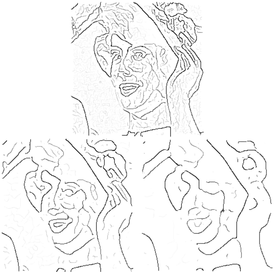
FIG. 6.6 – Les bords extraits à l'aide de l'algorithme de Canny aux échelles : 1, 5 et 10.
