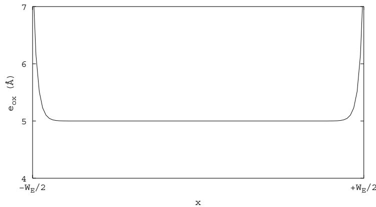
Figure 3.17 – Variation de l'épaisseur d'oxyde en fonction de l'abscisse pour un transistor de largeur effective W_E = 19,87\mu m en utilisant les valeurs e_0 = 5 \text{ \AA} , e_w = 7 \text{ \AA} et \lambda = 0,25\mu m
