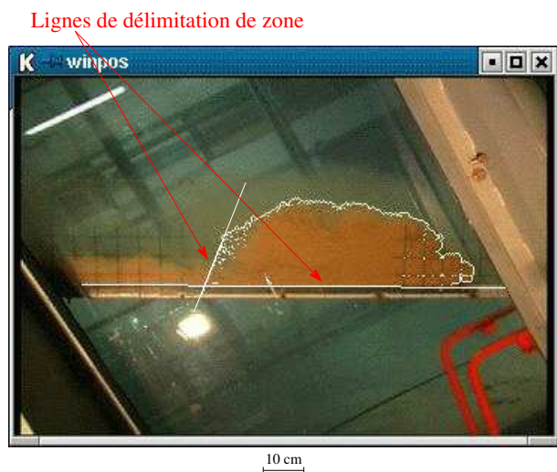
FIG. 5.8: Bouffée de sciure s'écoulant sur une pente de 32^\circ . Des délimitations de zones ont été ajoutées pour restreindre la zone d'intérêt.
