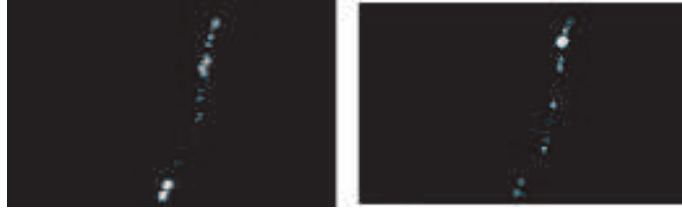
Figure 4.10: Filament vertical, en éclairage stroboscopique (temps d'exposition 20 \mu\text{s} ), 11.7 \times 6.8 \text{ cm} au centre, 2.5 \text{ ms} entre les deux images. R_\lambda = 1700 , p_0 = 141 \text{ mbar} , \Sigma \simeq 0.7 \Sigma_i .
