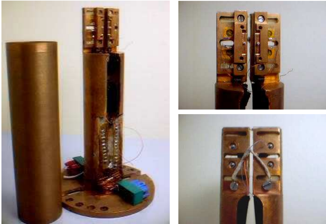
Figure IV. 7 : Cellule reconfigurable pour la mesure de la résistivité et du pouvoir thermoélectrique ou de la conductivité thermique. A gauche, la cellule de mesure et son écran de radiation dans la configuration pour mesurer la résistivité et le pouvoir thermoélectrique. En haut à droite, la tête de la cellule est constituée de deux fours mobiles permettant de mesurer des échantillons aussi petits que 9x9 mm. Des thermocouples placés dans des gaines d'alumine sont pressés contre l'échantillon à l'aide de deux ressorts à lame (en bas à droite). Les fours sont escamotables, permettant de libérer l'espace nécessaire à l'échantillon pour la mesure de la conductivité thermique par la méthode 3\omega .
