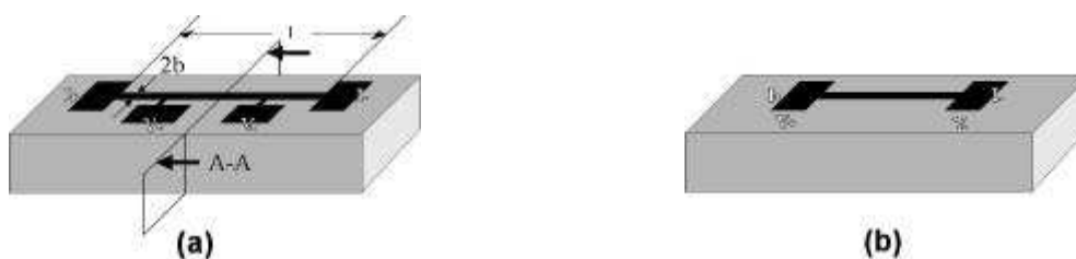
Figure II. 2 : Géométrie de l'échantillon pour la méthode 3\omega a) à quatre contacts et b) à deux contacts. Une bande métallique, ici en noir, sert à la fois d'élément chauffant et de thermomètre. Les contacts sont les connexions pour les amenées de courant ( I_+ , I_- ) et pour les prises de potentiel ( V_+ , V_- ). l est la distance entre les amenées de courant, 2b est la largeur de la bande chauffante et A-A est la vue de coupe de l'échantillon.
