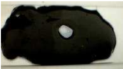
c. Protection à l'aide de cire-noire à l'exception de l'ouverture faite dans \text{SiN}_x/\text{SiO}_2/\text{SiN}_x .
