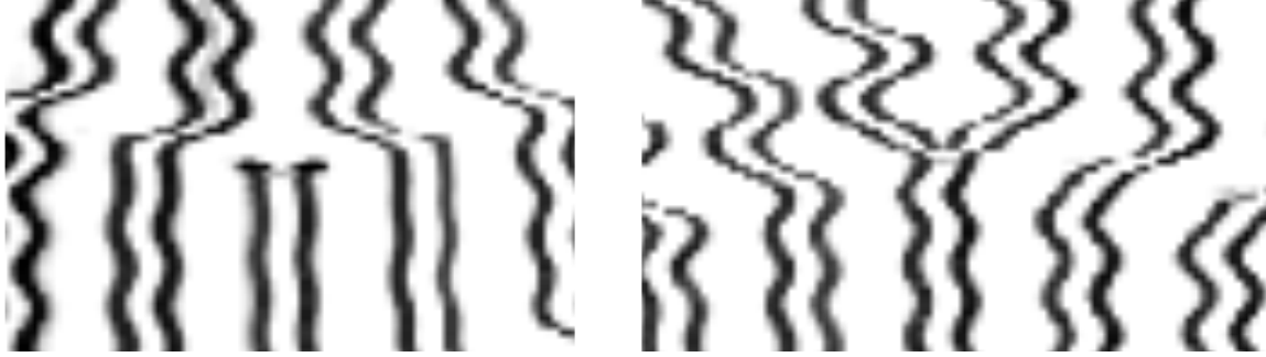
FIG. 2.13 – Zoom sur les défauts du motif lors d'un état chaotique. A gauche: défaut (+1), naissance d'une nouvelle colonne. A droite: défaut (-1), fusion de deux colonnes en une seule.
