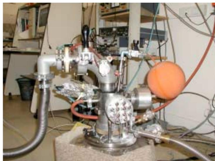
Photos numérique du cryostat à dilution
