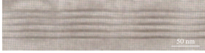
FIG. 4.2 – Image MET de l'échantillon B contenant 5 plans de boîtes de Ge distants de 25 nm.[70]
