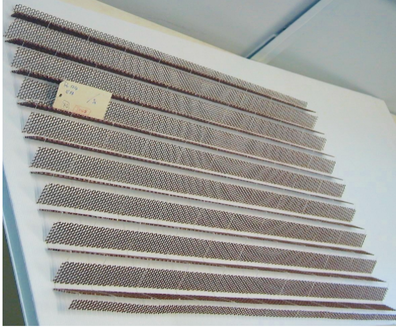
FIG. 3.6: Filet d'espaceur couvrant la moitié d'un absorbeur ou d'une électrode de la roue externe. Les fils rigides permettent de donner au filet la forme en accordéon.
