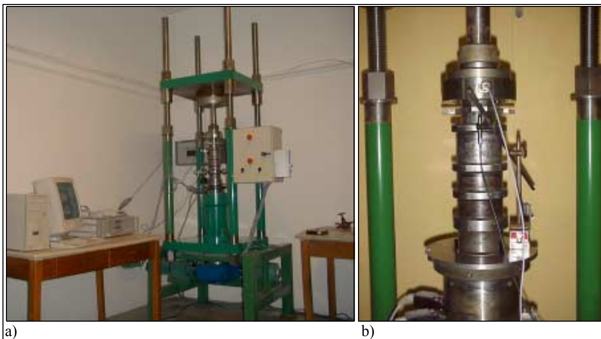
Figure 6.2 : Bâti de chargement lent : a) vue d'ensemble sur la presse et sur le système d'acquisition, b) plateau supportant la cellule et un capteur inductif de type LVDT ; le capteur de force de \pm 100 kN est situé au-dessus de la cellule
