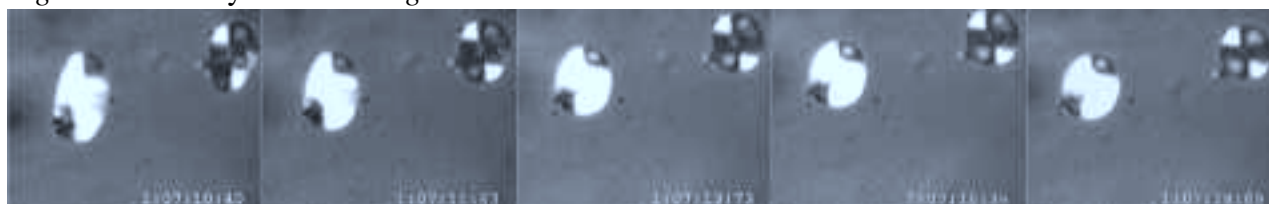
Figure VI-16: Gouttes de phase lamellaire plongée dans une phase éponge (dans la région de coexistence à une salinité de 1.6%) qui relaxent en fonction du temps après application d'un écoulement faible.
